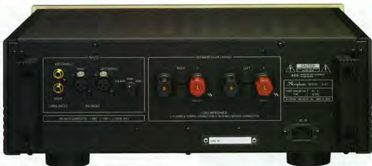
Sul pannello posteriore sono presenti sulla sinistra i connettori di ingresso sbilanciati e bilanciati e il commutatore che consente di scegliere la modalità di funzionamento (normale, dual mono o a ponte). Per il collegamento dei diffusori sono collocati nella parte centrale del pannello morsetti di pregevole fattura, com'è consuetudine Accuphase.
